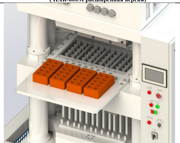
матрица для кирпича полнотелого 250 x 120 x 65 мм. (3шт.); 250 x 120 x 65 мм. (4шт.) ( ПАК-600М расширенная версия)
